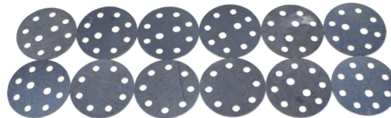
Mini-Nakazima (MN) & Mini-Punch (PU)
