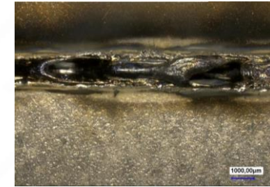
Aluzinc® (AZ) coating vaporisation
